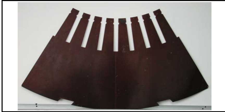
Figura 1.1 Ejemplo de laminación del núcleo del estator de un turbo generador.
